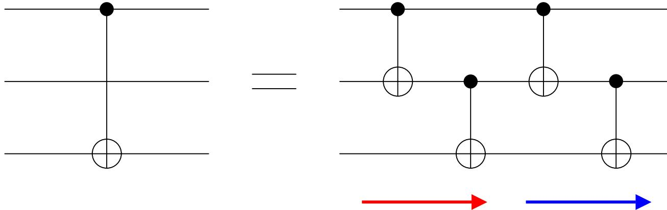
$$\begin{aligned} |a\rangle|b\rangle|c\rangle &\xrightarrow{C_{12}} |a\rangle|b\oplus a\rangle|c\rangle \\ &\xrightarrow{C_{23}} |a\rangle|b\oplus a\rangle|c\oplus b\oplus a\rangle \\ &\xrightarrow{C_{12}} |a\rangle|(b\oplus a)\oplus a\rangle|c\oplus b\oplus a\rangle = |a\rangle|b\rangle|c\oplus b\oplus a\rangle \\ &\xrightarrow{C_{23}} |a\rangle|b\rangle|(c\oplus b\oplus a)\oplus b\rangle = |a\rangle|b\rangle|c\oplus a\rangle \end{aligned}$$
